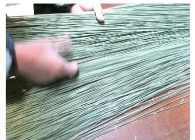
選別したイ草を機械に入れ、水蒸気で加湿します。この加湿の具合によって畳表の色調や表情が変わるためとても重要な工程です。その日の温度や湿度によってイ草の声を聴き、加湿の塩梅を微妙に調整していきます。
