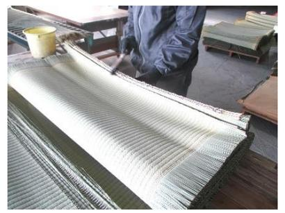
まず畳表を注文されたサイズに裁断していく作業を見せていただきました。畳のサイズは関西、中京、関東など地域によって異なるため、発注されたサイズに合わせて一枚一枚手作業で切っていきます。裁断した後は解れないように端を糊止めします。
